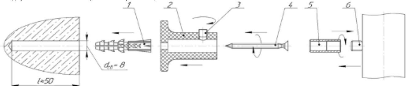
Прикрепите пластиковую часть кронштейна 2 к стене. Закрепите винтом 4. Прикрутите насадку 5 к крепежному винту 6 сушителя до упора. Выполните указанные действия для всех крепежных элементов. Вставьте насадки 5, прикрученные к сушителю, в отверстия пластиковых креплений 2, прикрученных к стене. Закрепите насадки 5 с помощью винтов 3.
